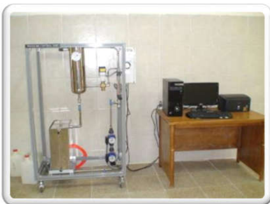
دستگاه کنترل فشار
