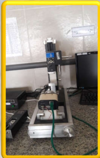
دستگاه اندازه گیری کشش سطحی و زاویه تماس
